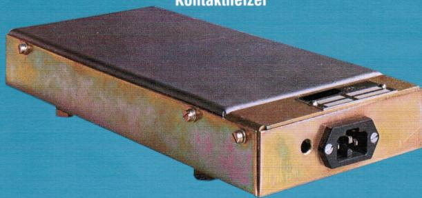
**CARATTERISTICHE GENERALI:** Questi riscaldatori hanno il termostato incorporato e sono particolarmente adatti per il preiscaldamento dei motori endotermici, sono applicati a contatto sotto la coppa dell'olio mediante appositi bulloni di pressione, come indicato in Fig. 2. Per aumentare la conducibilità di calore vengono forniti completi di lamina di piombo.
