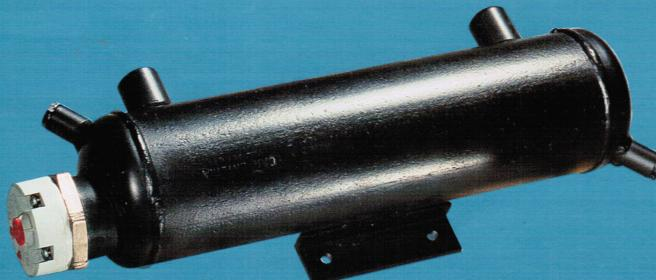
**CARATTERISTICHE GENERALI:** i riscaldatori della serie AQ sono particolarmente adatti per il preriscalo dei motori endotermici raffreddati ad acqua. Hanno termostato tarabile incorporato. Nell'applicazione si sfrutta la circolazione naturale dell'acqua con sistema a termosifone.
